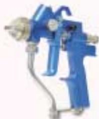
Este modelo es ideal para trabajos exigentes y adecuado para el rociado de Frekote® 1-Step de Loctite®. El rociado HVLP (High Volume Low Pressure, gran volumen baja presión) es más eficiente, rentable y produce el mismo terminado fino y a la misma velocidad que las pistolas de rociado clásicas de aire comprimido, sin los inconvenientes de exceso de rociado, rociado fuera del objetivo y contaminación del aire.
