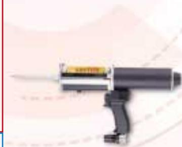
La pistola manual de cartucho doble de 200 ml de Loctite® se acciona neumáticamente. Proporciona un método conveniente y rentable para aplicar el producto, desperdiciando lo menos posible. Se controla la cantidad aplicada mediante el regulador integrado de presión del aire. Es apto para productos con relaciones de mezcla 1:1/1:2.
