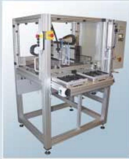
Sistemas automáticos de aplicación de silicona para juntas con robots x/y
